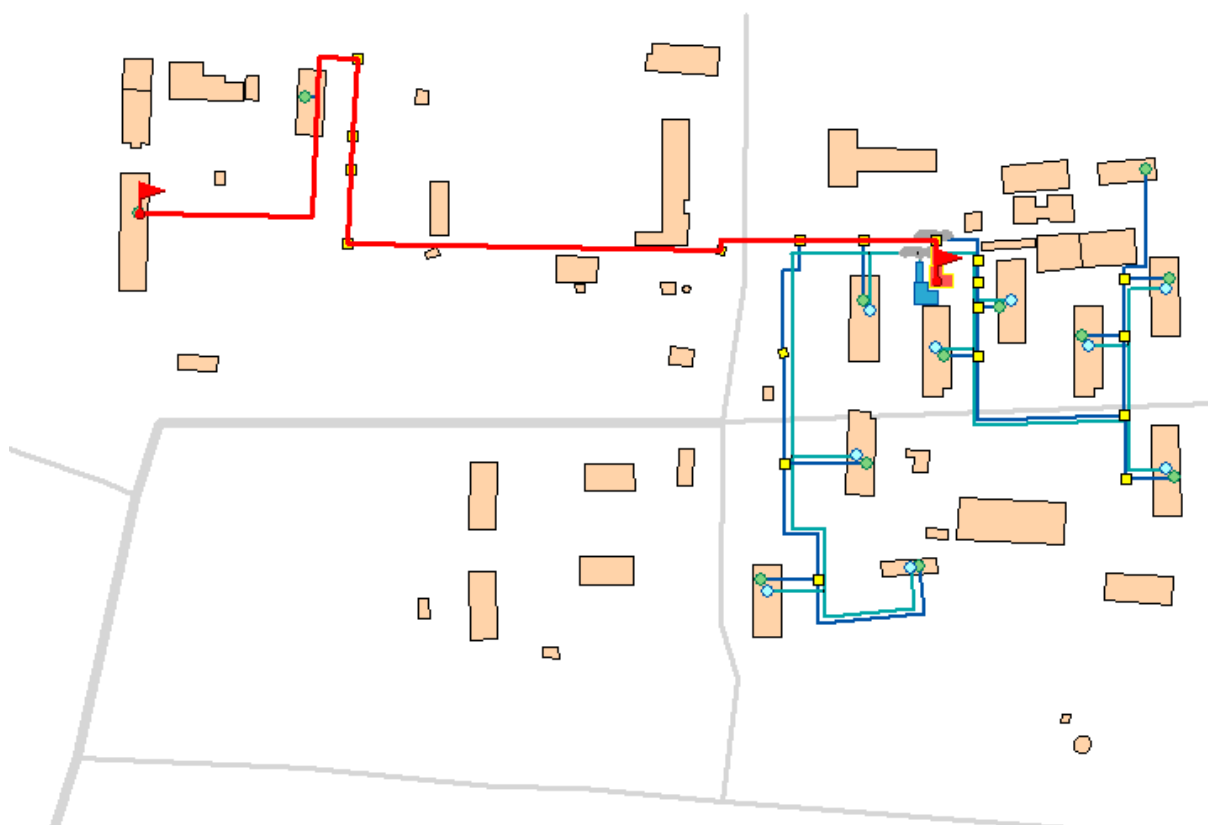
Рисунок 3.21 – Трассировка теплопровода от котельной пос. Молодежный до конечного потребителя «ул. Магистральная, д. 43» (расчетный путь 4-1)
