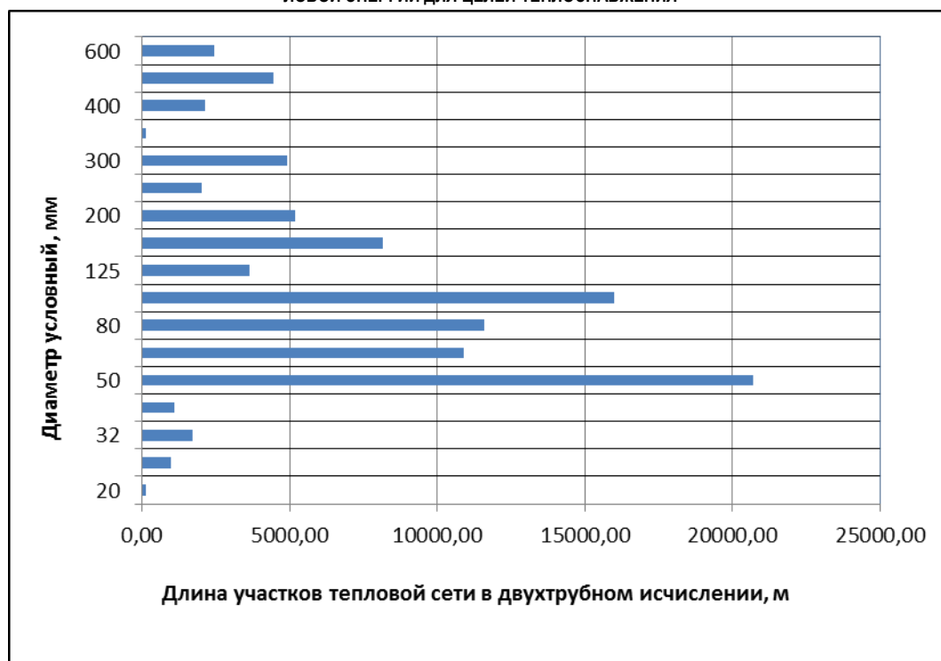
Рисунок 3.1 – Распределение протяженности трубопроводов тепловых сетей по диаметрам
